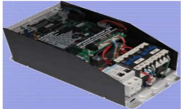
Şəkil 1.7. Mərtəbəyə qalxma/düşmə prosesini idarə edən qurğu
